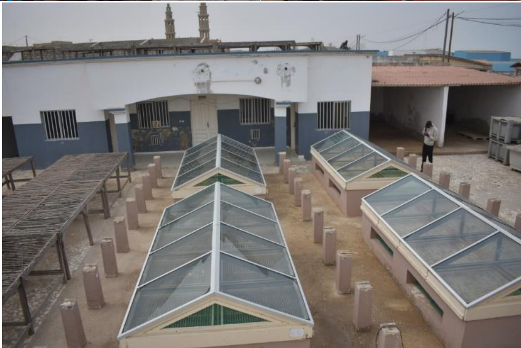
Unité améliorée de transformation : four de fumage et claies de séchoirs solaires / Crédit-Photos : Moussa CISS, Cheikh NDIAYE
